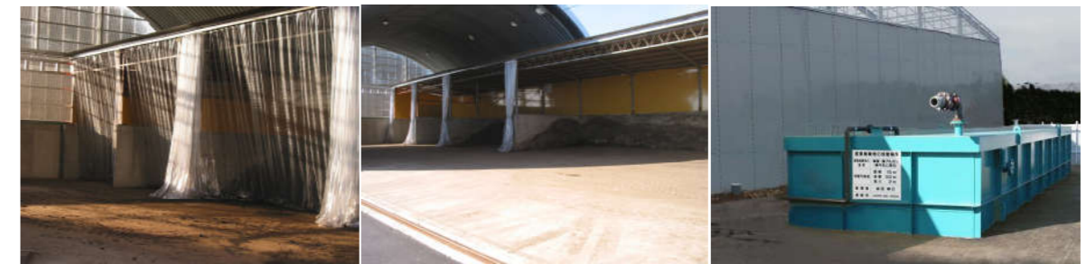
車両により場内に搬入された原料は、汚泥・動植物性残渣・木くず、廃酸・廃アルカリ(牛乳・ヨーグルト等)の種類別に受入します。
